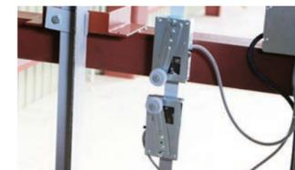
昇降機が接触すると、カゴ停止装置が作動し、カゴが停止します。
