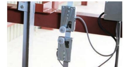
昇降機が接触すると、カゴ停止装置が作動し、カゴが停止します。
