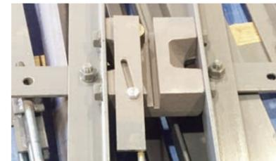
ワイヤーロープが破断したときに、カゴの落下を防止します。
